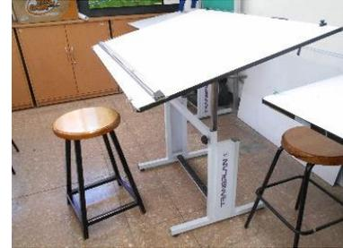
Imagen 6. Restirador con regla paralela. (Cadena: 2018).
